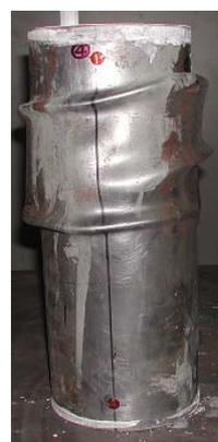
図-5 (a) CFDST のせん断破壊形態
