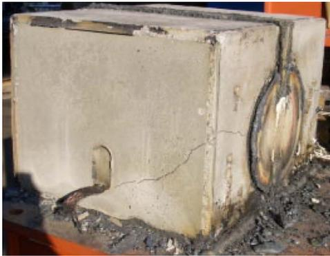
写真2 充填コンクリートのひび割れ状況
