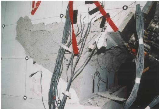
図-7 ひび割れ図および破壊状況
