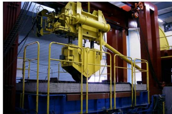
図-11 輪荷重走行試験機
