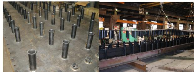
パイプジベル溶接 上下鋼板の組立
