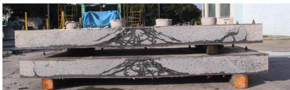
図-8 版部材による静的載荷試験後の切断面
