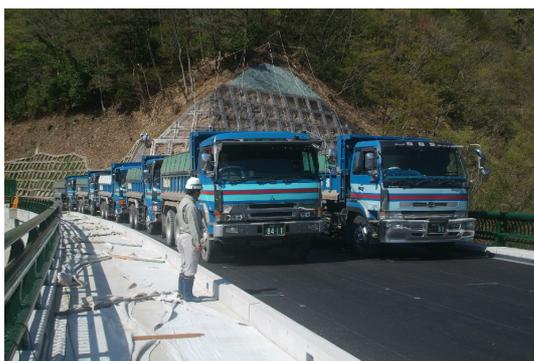
写真-1 静的荷重実験状況
