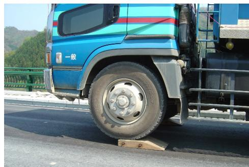
写真-2 衝撃加振実験状況
