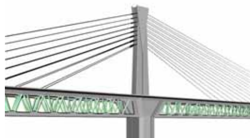
図-16 エクストラードード複合トラス橋
