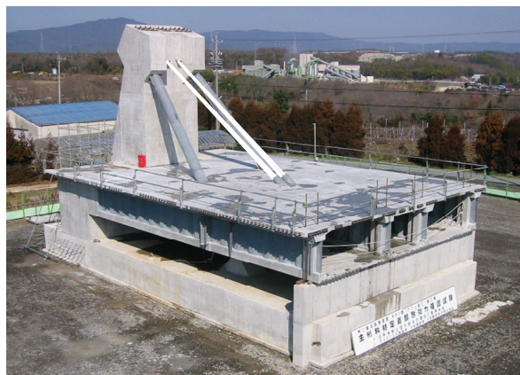
写真-1 斜材定着部の耐力確認実験供試体
