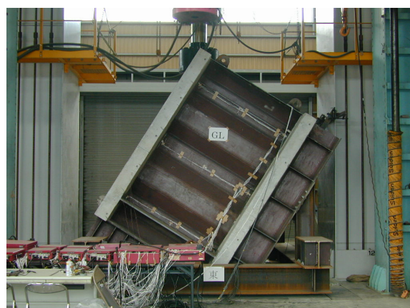
写真-2 疲労試験状況
