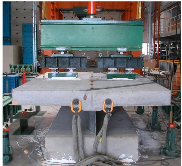
写真-6 押抜きせん断試験状況
