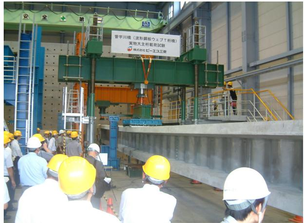
写真-5 曲げ载荷試験状況
