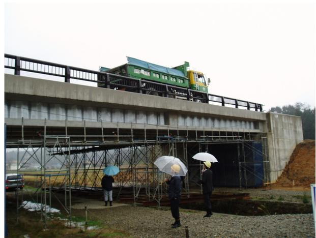
写真-7 実橋載荷試験状況
