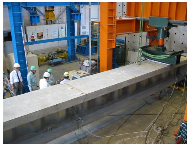
写真-4 せん断載荷試験状況
