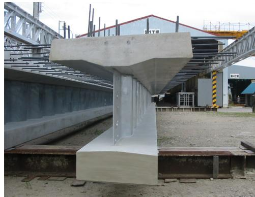
写真-2 コルティエー桁断面
