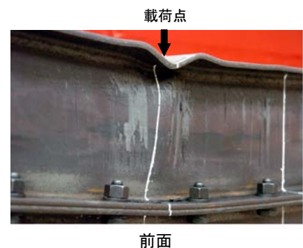
図-10 SN-Nにおける実験結果の変形状況写真，解析結果 (Case2) の変形図およびウェブの軸方向ひずみ分布
