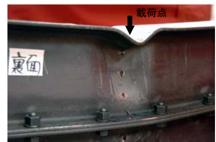
(c) 実験終了後の変形状況写真
