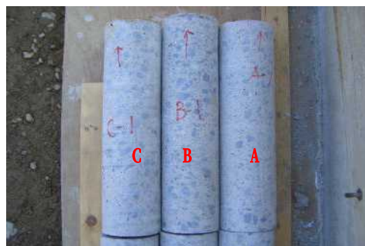
写真 2 骨材の分離状況
