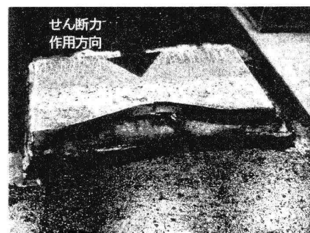
写真-1 前面載荷による疲労破壊
