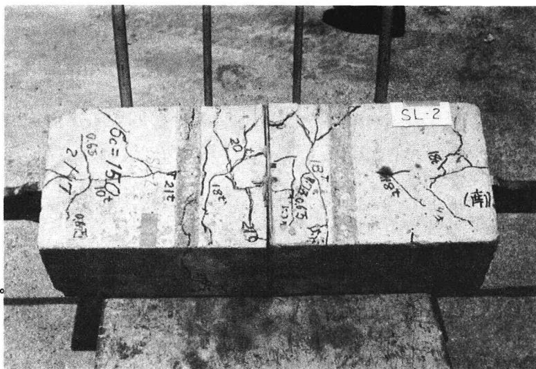
写真2 試験体のひびわれ状況
