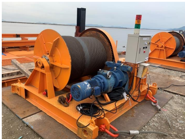
図-6 打設船を移動させるウインチ
