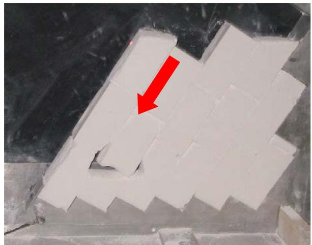
写真-11 傾斜角120°千鳥状態の場合 振動実験の崩壊の様子<sup>10)</sup>
