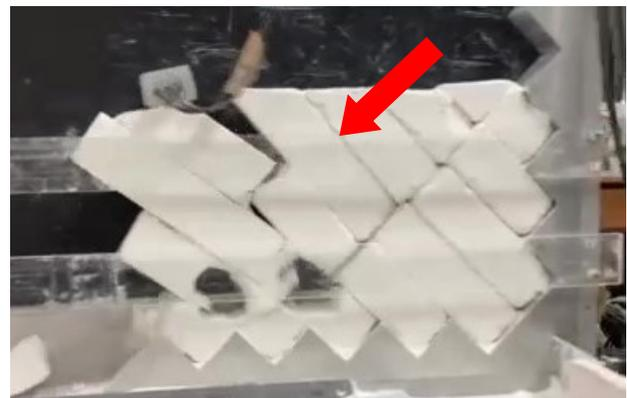
写真-8 傾斜角135°層状態の場合 振動実験の崩壊の様子
