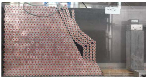
写真-6 柱の座屈破壊
