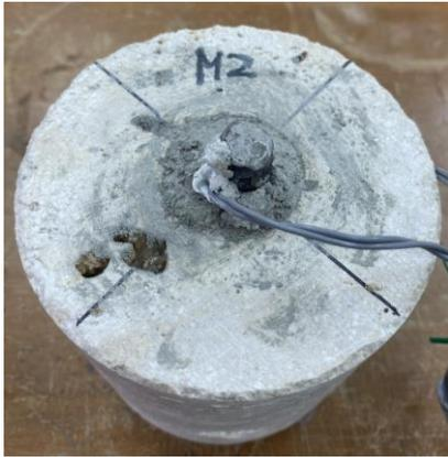
図-6 ロックボルト押し抜き試験供試体
