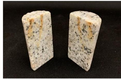
図-1 平滑な不連続面を有する円柱供試体
