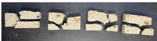
図-12 大谷石Dのひび割れの様子(写真の奥行方向が堆積面に平行な方向を示す)
