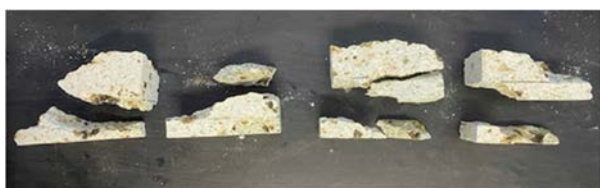
図-11 大谷石Cのひび割れの様子(写真の奥行方向が堆積面に平行な方向を示す)
