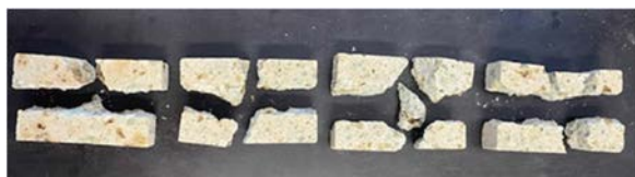
図-10 大谷石Bのひび割れの様子(写真の奥行方向が堆積面に垂直な方向を示す)
