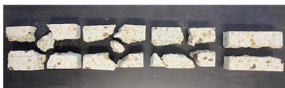
図-9 大谷石Aのひび割れの様子(写真の奥行方向が堆積面に垂直な方向を示す)
