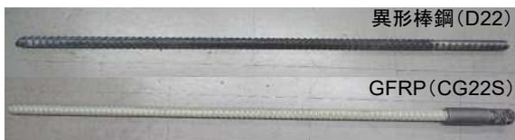
写真-2 本試験で使用したロックボルト (1.0mの例)
