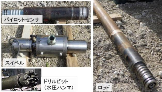
写真-1 削孔機械に取り付けるデータ送信装置とドリルビット
