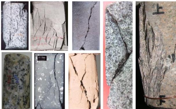
写真-6 室内圧縮試験における断層破碎帯の形成
