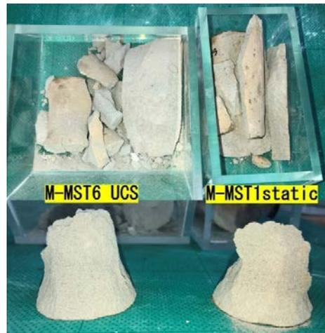
図-17 御嵩地区の泥岩(M-MST1 static および M-MST6 UCS)の試験後の破壊状態の比較
