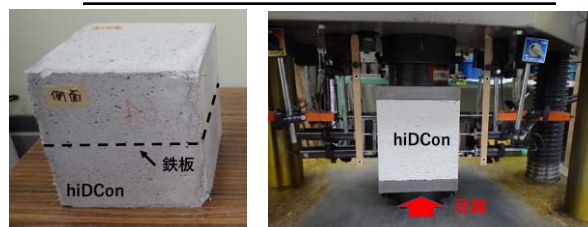
図-4 供試体写真（左）と載荷状況（右）
