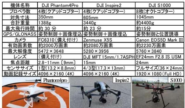
図-4 比較検証に用いた UAV と搭載カメラの仕様<sup>1)</sup>
