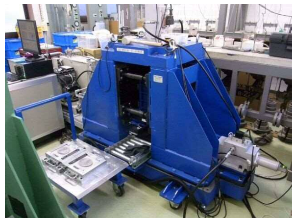
図-1 動的載荷試験装置・全景
