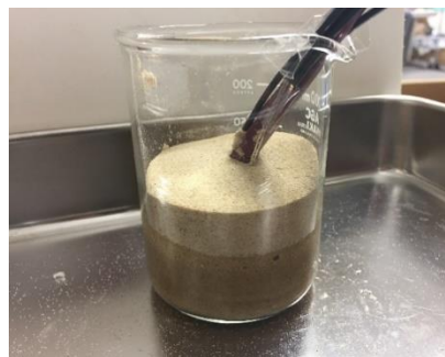
写真-3 RRセンサーを設置したサンプル
