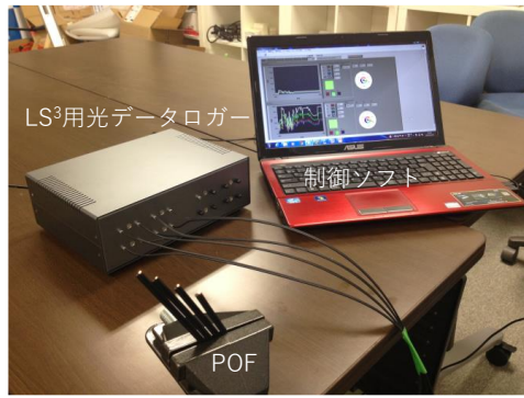
写真-1 POFを用いた光データ計測に使用する装置
