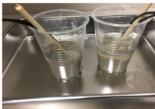
写真-9 作成直後のセメント供試体
