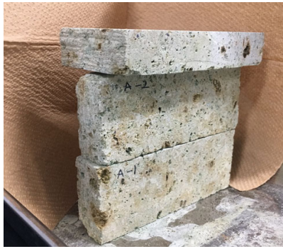
図-9 大谷石供試体を組み合わせた大谷石擁壁モデル
