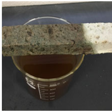
図-14 紅茶の酸化反応による黒錆変化
