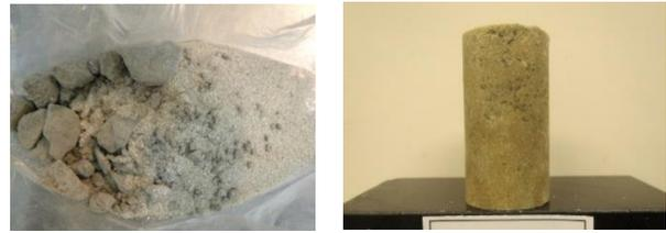
図-5 使用した泥岩材料およびウレタン改良体
