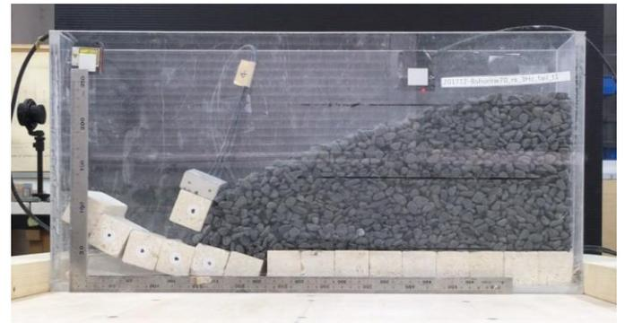
図-7 崩壊状況(入力加速度約383gal)
