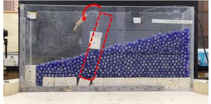
図-5 崩壊状況(入力加速度約246gal)
