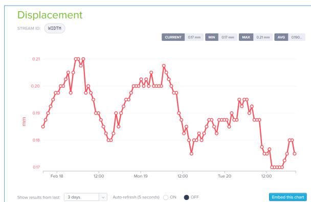
図-2 クラウド上に表示された亀裂変位の経時変化
