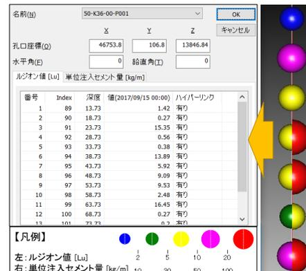
図-6 グラウト施工記録の三次元表示方法
