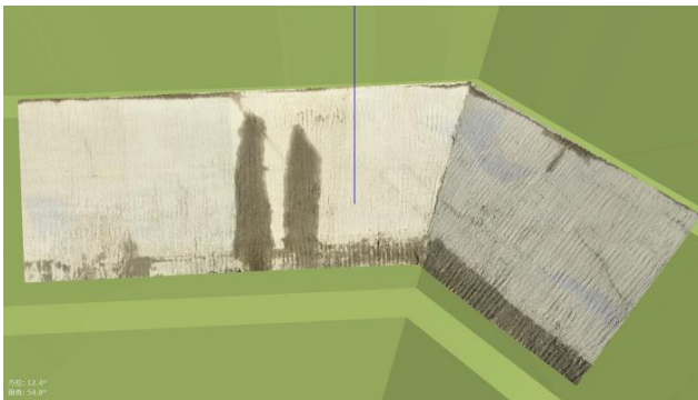
図-9 法面地質状況写真 CIM 表示例
