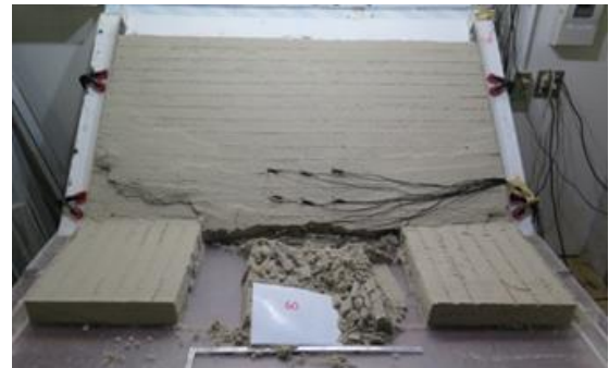
写真-5 全体崩壊
