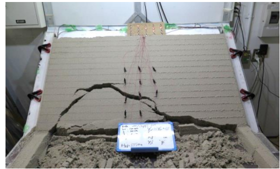
写真-4 非対称アーチ型崩壊
