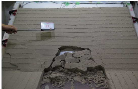
写真-3 斜面崩壊が生じた供試体(アーチ型崩壊)
