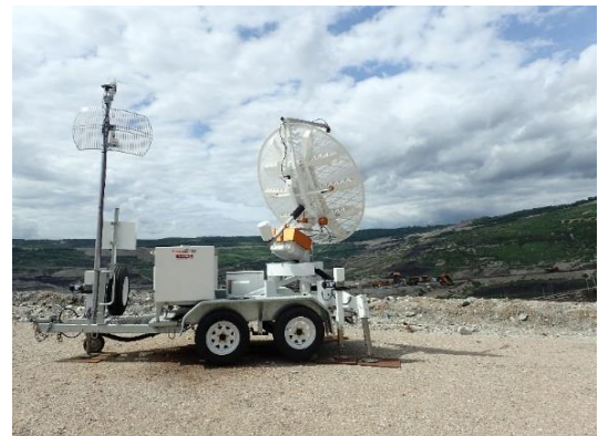
写真-1 斜面レーダー観測機 (2016/9/5 Mae Moh鉱山)
