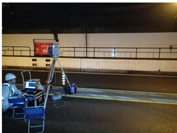
写真-2 3Dスキャナー測定状況
