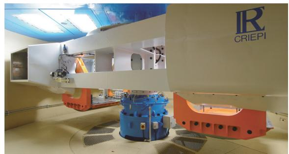
図-2 本実験で用いた遠心力载荷装置。
