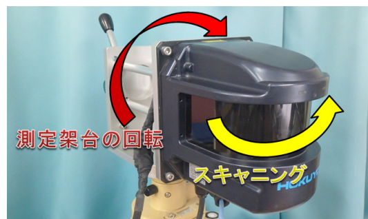
写真-3 3次元計測の仕組み
