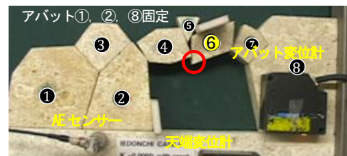
写真-3 モデルAの自重載荷試験による変形破壊性状
