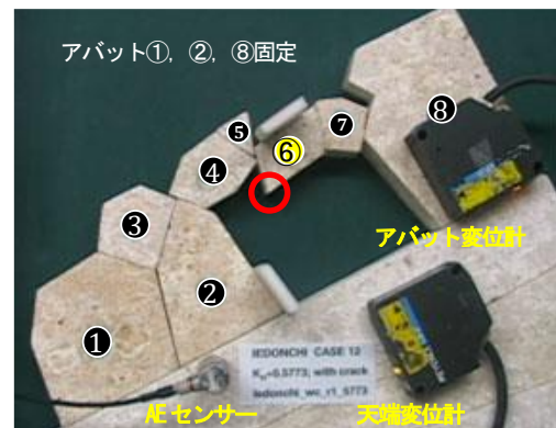
写真-4 モデルAの地震時水平力載荷実験による変形破壊性状（水平震度係数： k_h = 0.58 ）
