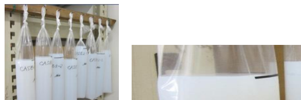
写真5-1 ブリーディング試験実施状況
