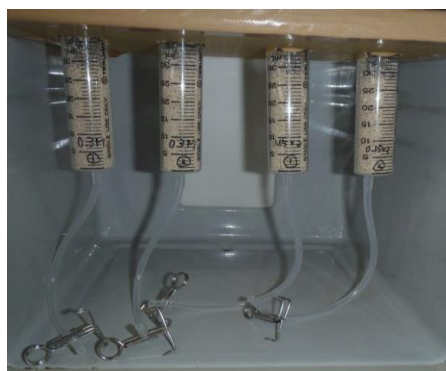
写真-2 シリンジ固化試験の様子
