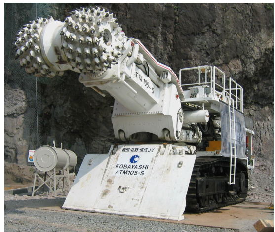
写真-2 300kW 級横軸（クロスヘッド）型掘削機
