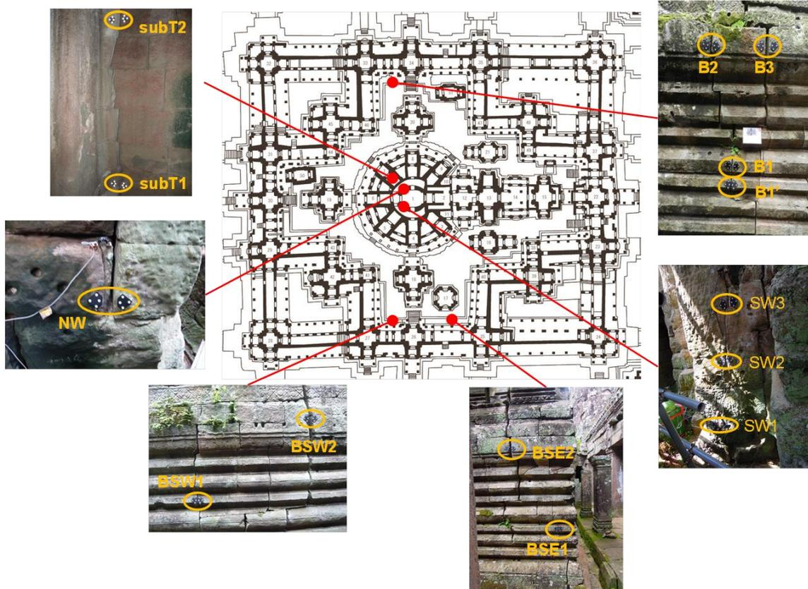
図-5 バイヨン寺院中央塔におけるターゲット設置位置 (図の上が北を示す)
