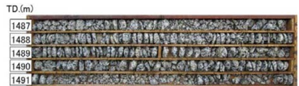
図-8 TD. 1487 m～TD. 1492 m 区間のボーリングコア
