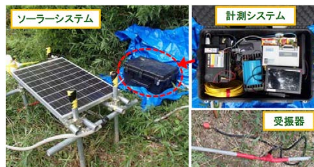
図-3 地表計測システム
