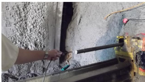
写真-1 内視鏡挿入状況
