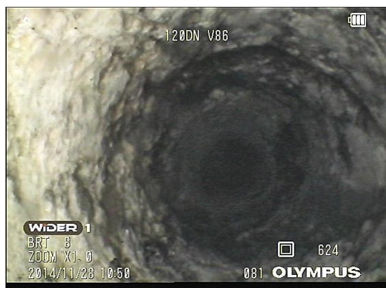
写真-7 孔壁画像（混在岩；玄武岩優勢部）
