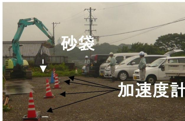
図-3 落下試験と振動計測システム
