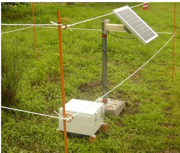
図-2 地震観測システムの様子
