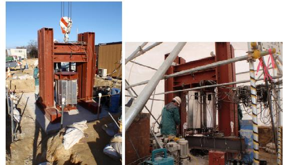
写真-1 試験の様子(左:反力設置, 右:試験直前)
