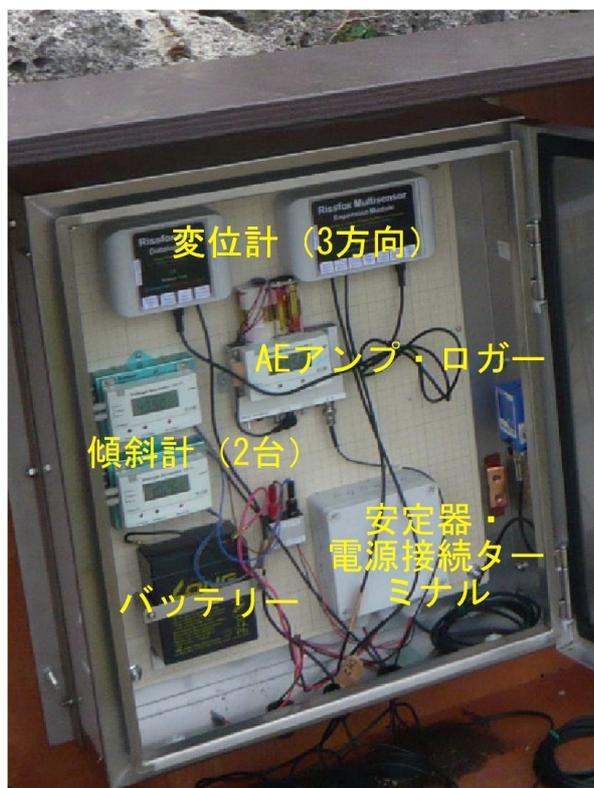
図-6 計測装置収納ボックスの構成
