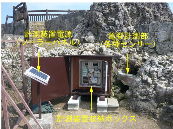
図-5 多重パラメータ動態観測システム
