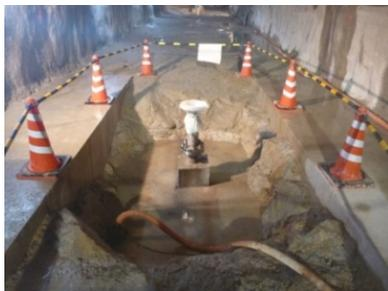
図-2 岩盤変位観測用のボーリングピット
