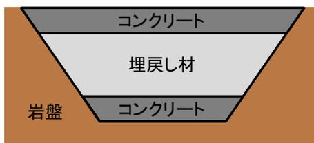
図-4 埋戻しの概念図
