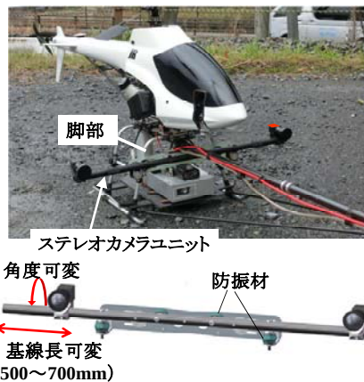
図-2 空撮測量システムとステレオカメラユニット
