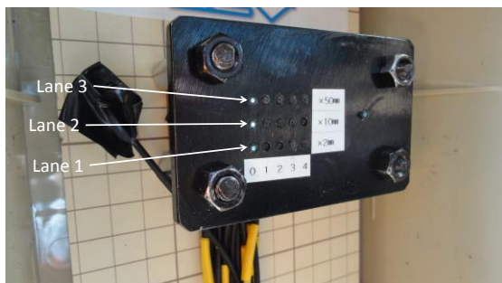
図-8 変位を視認するためのボード
