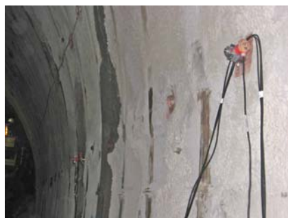
ロックボルト頭部に取り付けた受振センサ
